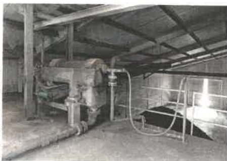
De decanter om de drijfmest te scheiden in een dikke en dunne fractie.
